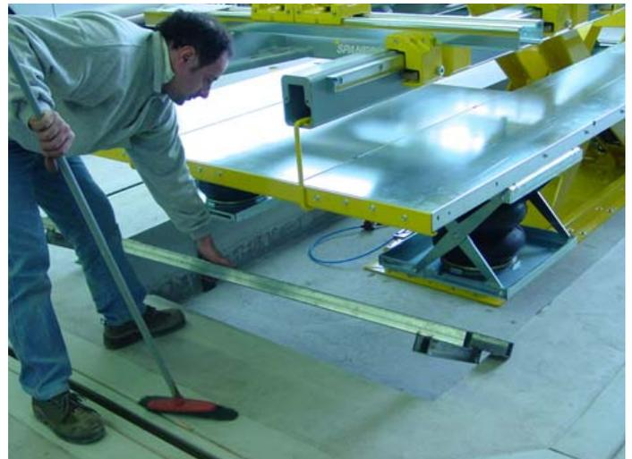
Togliere i due sostegni pedana infossata (vedi fig. 27) e inserirli all'interno della fossa nel senso della lunghezza, uno a destra e l'altro a sinistra della pedana stessa. I sostegni non dovranno più essere utilizzati se non in caso di assoluta necessità per manutenzioni sulla pedana stessa. (vedi fig. 28).
